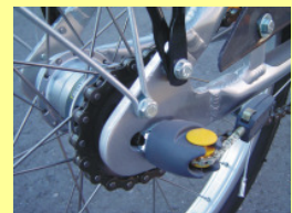
Typ C (gilt für beide Abbildungen) Nabenschaltung mit Klick-Box (z.B. Sram) oder Schaltzug durch die Radachse
