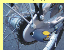
Typ C (gilt für beide Abbildungen) Nabenschaltung mit Klick-Box (z.B. Sram) oder Schaltzug durch die Radachse
