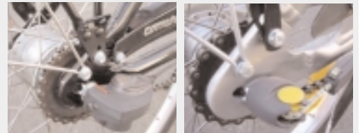
Typ C (gilt für beide Abbildungen) Nabenschaltung mit Klick-Box (z.B. Sram) oder Schaltzug durch Nabe
