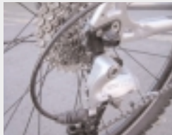
Typ A (Standard) Kettenschaltung mit Hohlachse (Schnellspanner)
